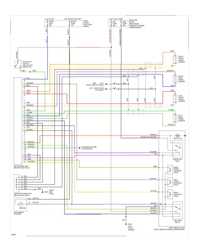
ANTI-LOCK BRAKE SYSTEM 1994 BRAKES Mazda - Anti-Lock
