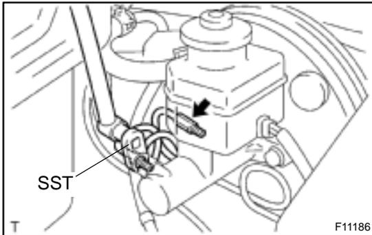
4. DISCONNECT BRAKE LINES FROM BRAKE MASTER CYLINDER
