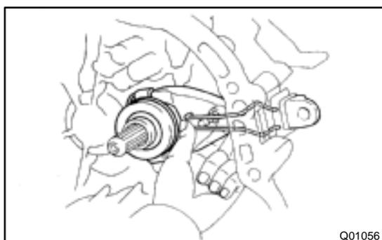
3. **REMOVE RELEASE BEARING AND FORK FROM TRANSAXLE**
